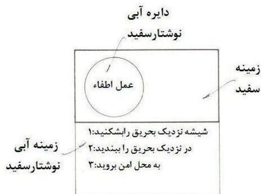
شکل ۳-۸: دادن اطلاعات ایمنی حریق
